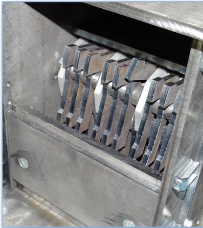
Blick auf das Mahlwerk mit verstärktem Material
